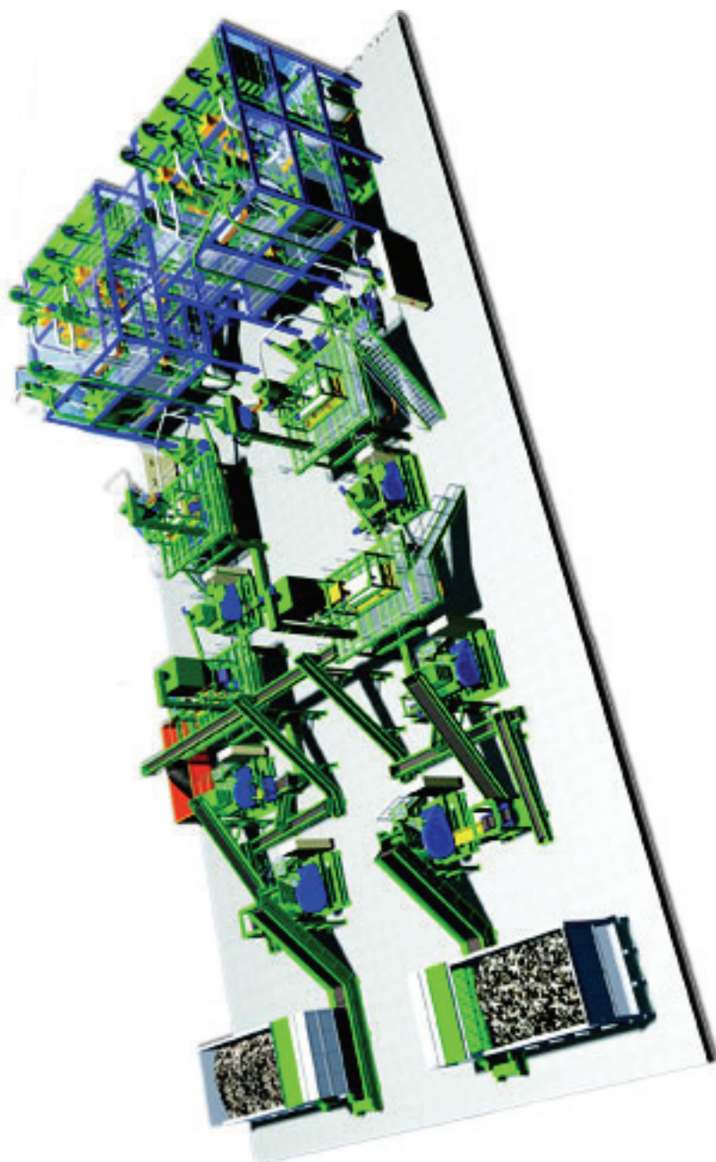
Figura nr. 2.3 Schema de funcționare a unei facilități pentru tratarea deșeurilor din cauciucuri și anvelope uzate
